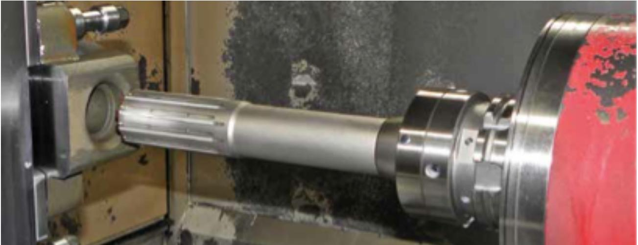
Dem Hydraulik-Spezialisten Bosch Rexroth in Lohr gelang es, mithilfe von Vielschneiden-Reibahlen des Herstellers Sumitomo die Produktivität beim Reiben um den Faktor zehn zu steigern. Ein Produktionsengpass wurde beseitigt; die Standzeiten verlängerten sich deutlich.
